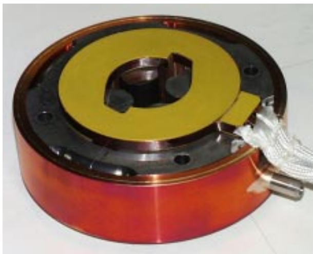
図3 絶縁材を取付け、コアに組込んで、DT用冷却水ジャケットで焼ばめ組立てした直後の写真
