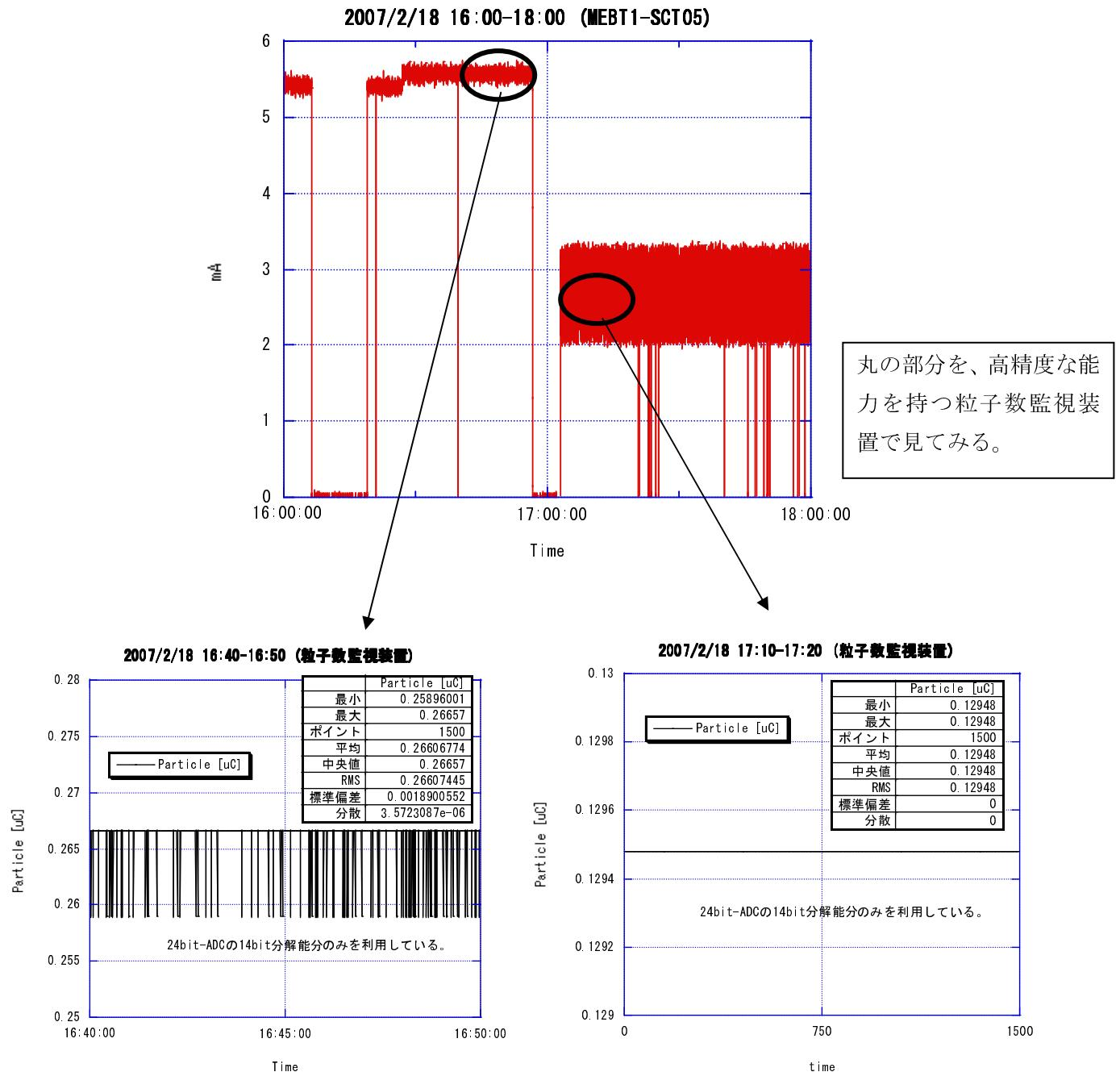
粒子数監視装置は、24 ビット分解能であるが、上位にはそのうちの 14 ビットだけを転送してくる。14 ビット分解能でも、チョッパされたビームは揺らぎが検出されていない。かなり安定した状態である。このデータより、チョップ前後で平均電荷量を見ると、チョッピングの効率は 48.5% である。
