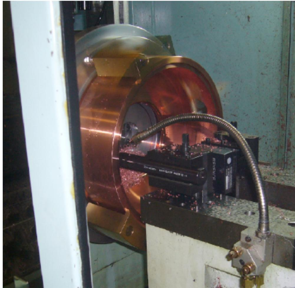
面粗度0.4S 鏡面加工：RF的にも真空的にも過剰？
